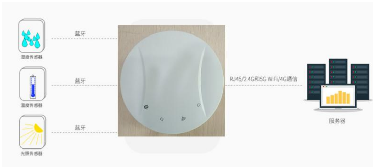
图 1.5.1 蓝牙网关采集蓝牙传感器信息
